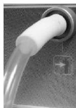
Das andere Schlauchpaar an das externe Entlastungsventil anschließen.
